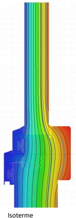
NOTE: Calcolato come da UNI EN ISO 12567-1:2010 (Finestra 1 anta 1230x1480 mm) (Portafinestra 1 anta 1480x2180mm).  $U_g = 0,6 \text{ W/m}^2\text{K}$   $\gamma = 0,04 \text{ Wm}^2\text{K}$ . Dati di progetto: temperatura esterna di 0°C temperatura interna di 20°C e 65% di umidità.
